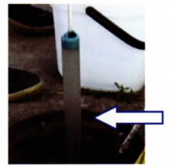
観測井戸 地下水濁り
