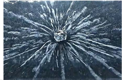
ウイルソンの霧箱による放射線観察 Thermoelectric Cloud Chamber より https://www.youtube.com/watch?v=XGNvAEtYZkw
